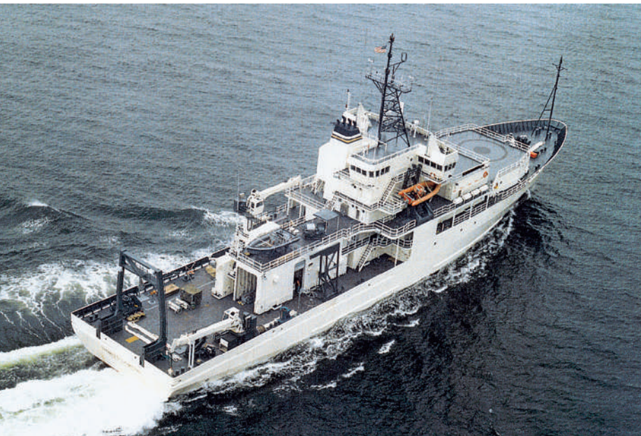
FIGURA 1.9 O Navio de Pesquisa Thomas G. Thompson , operado pela Universidade de Washington, é o primeiro de uma nova geração de navios de pesquisa. Estes navios oferecem mais espaço de trabalho e podem viajar para os locais de pesquisa mais rapidamente, permanecendo lá por mais tempo que os navios de pesquisa anteriores.
